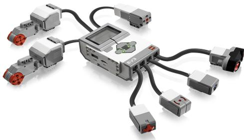
Es besteht aus mehreren Aktoren (Schrittmotoren), Sensoren und dem NXT- bzw. EV3-Stein. Er ist das eigentliche Steuerteil – ein richtiger kleiner Computer. Wir bauen die verschiedenen Fahrzeuge und lernen, wie man diesen kleinen Fahrroboter programmiert.
